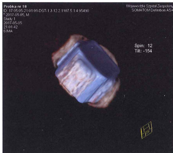
Rys. 9. Obraz rekonstrukcji próbki stalowej z wyraźnie widoczną łuną odbicia promieniowania X Fig. 9. Image of the reconstructed steel sample with clearly visible x-ray reflection glow
